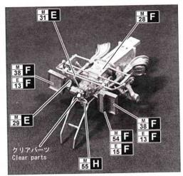
●フロントセクションの組み立て Front section assembly
