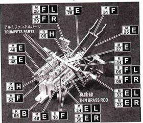
\*ボディーとエンジンの取付は、中ビスをお使い下さい。 \*The attachment of a body and an engine should use an inside screw.
