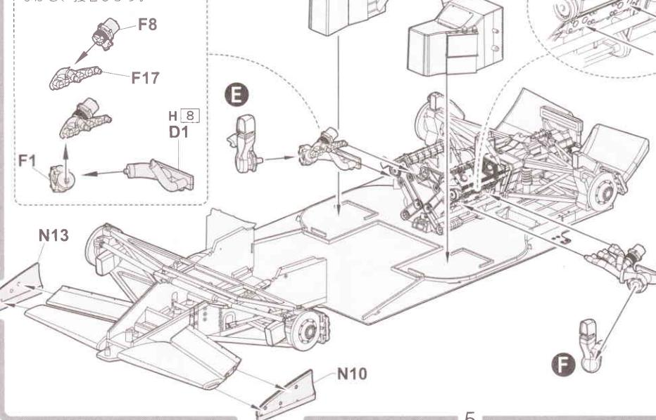
エンジン・車体に組み付けながら、接着します。
