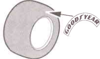
② タイヤのほこり、油気を取り文字が正しく読めるようにマークを合わせ、上から水をつけた指先でなでるようにします。
