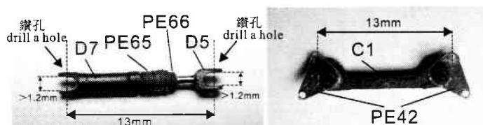
先用少量膠水固定C1和PE42，但不要粘太牢固，方便之後調整
